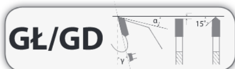
GL/GD елочно-прямой зубчатый венец с дуговой передней гранью
